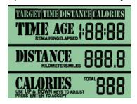
В секции дисплея «Целевое значение» отображаются значения времени, расстояния и калорий в течение всех программ тренировки. В верхней части дисплея отображается выбранного параметра. В секции «Время» может отображаться как время, оставшееся до
